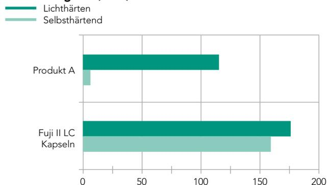
Fuji II LC zeigt eine hohe Druckfestigkeit sowohl im Selbsthärtungs- als auch im Lichthärtungsmodus. Quelle: Interne Daten aus der F&E von GC
